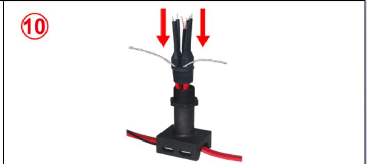
10 : Füllen Sie die Öffnung der Silikonmanschette mit Silikonharz (RTV). Schieben Sie die Manschette über die Leiter der Heizkabel und lassen Sie den Schutzleiter draußen. Diese Manschetten können auch durch einen Schrumpfschlauch ersetzt werden.
