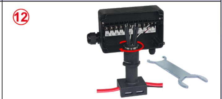
12 : Legen Sie die Dichtung in die obere Aussparung des Fußes, dann den Kasten darüber. Richten Sie den Kasten entsprechend der gewünschten Position aus, setzen Sie dann die Zahnmutter auf und ziehen Sie sie fest, bis sie fest sitzt.
