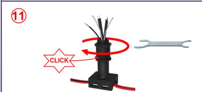
11 : Drücken Sie die Dichtung zusammen, indem Sie den oberen Teil des Fußes anschrauben. Nach dem Festziehen kommt eine kleine Feder zum Einsatz, die das Ganze versperrt (zur Demontage muss diese kleine, halbkreisförmige Feder entfernt werden).
