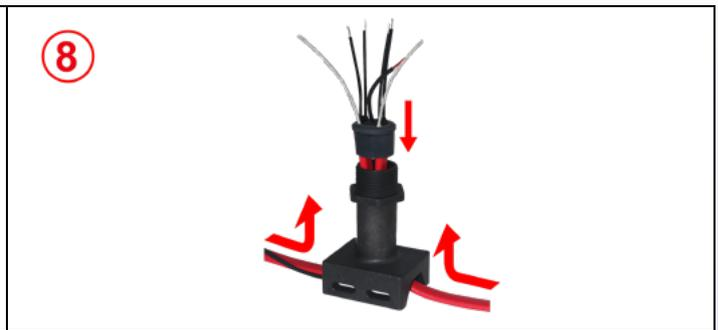
8 : Setzen Sie den Fuß auf die Heizkabel und auf das Temperatursensorkabel, führen Sie sie oben heraus und schieben Sie dann die Dichtung über die Kabel. Der äußere Isoliermantel muss über die Dichtung hinausragen.
