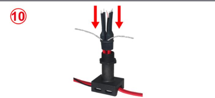
**10:** Llene la boca de la cubierta de silicona con resina de silicona (RTV). Deslizar la cubierta sobre los conductores de los cables de calefacción, dejando el conductor de tierra afuera. Estas cubiertas también pueden ser reemplazadas por un tubo termorretráctil.
