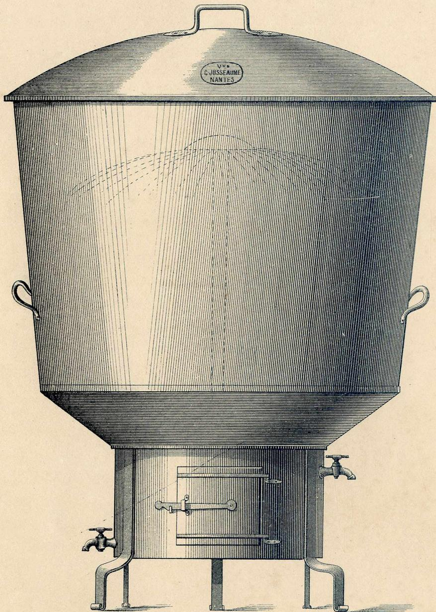
**LESSIVEUSE** économique à circulation toute en cuivre rouge étamé de 100 litres à 1200 litres de contenance, avec tube d'arrosage mobile, ne demandant d'autre travail pour lessiver parfaitement le linge que d'entretenir le feu dans le foyer de l'appareil pendant 4 heures environ.
