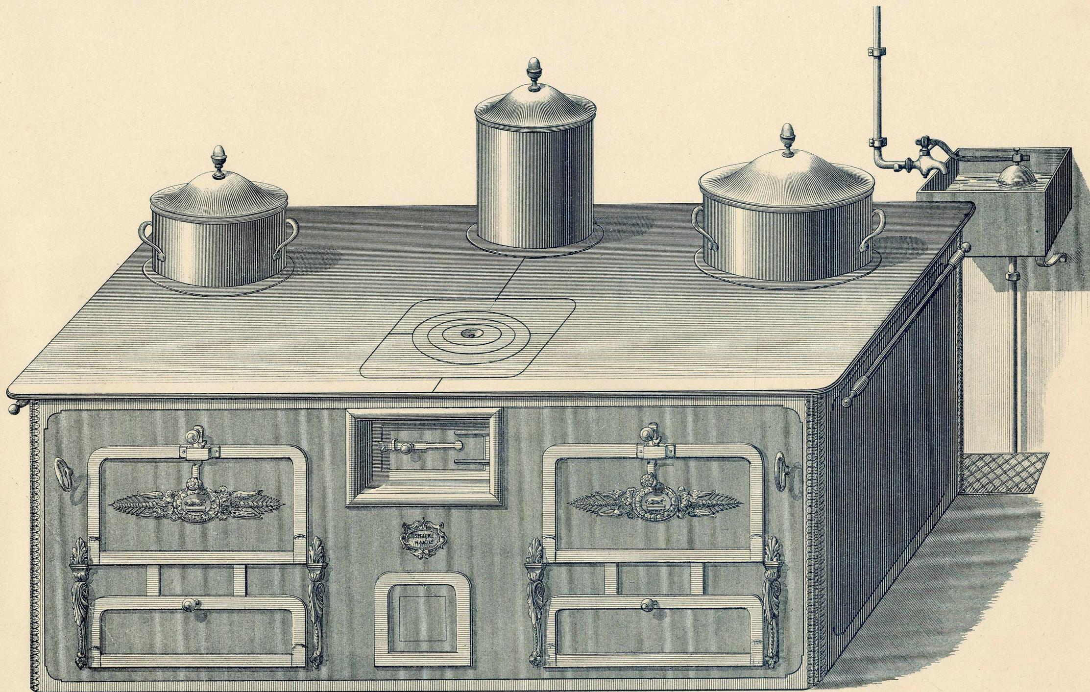
**FOURNEAU** économique à 2 façades avec fours ventilés, petites étuves, deux bassines et une chaudière à eau en cuivre ayant son robinet dans la seconde façade, porte du foyer au fond d'une baie. La plaque au dessus du foyer permet de changer ce dernier sans lever les grandes plaques.
