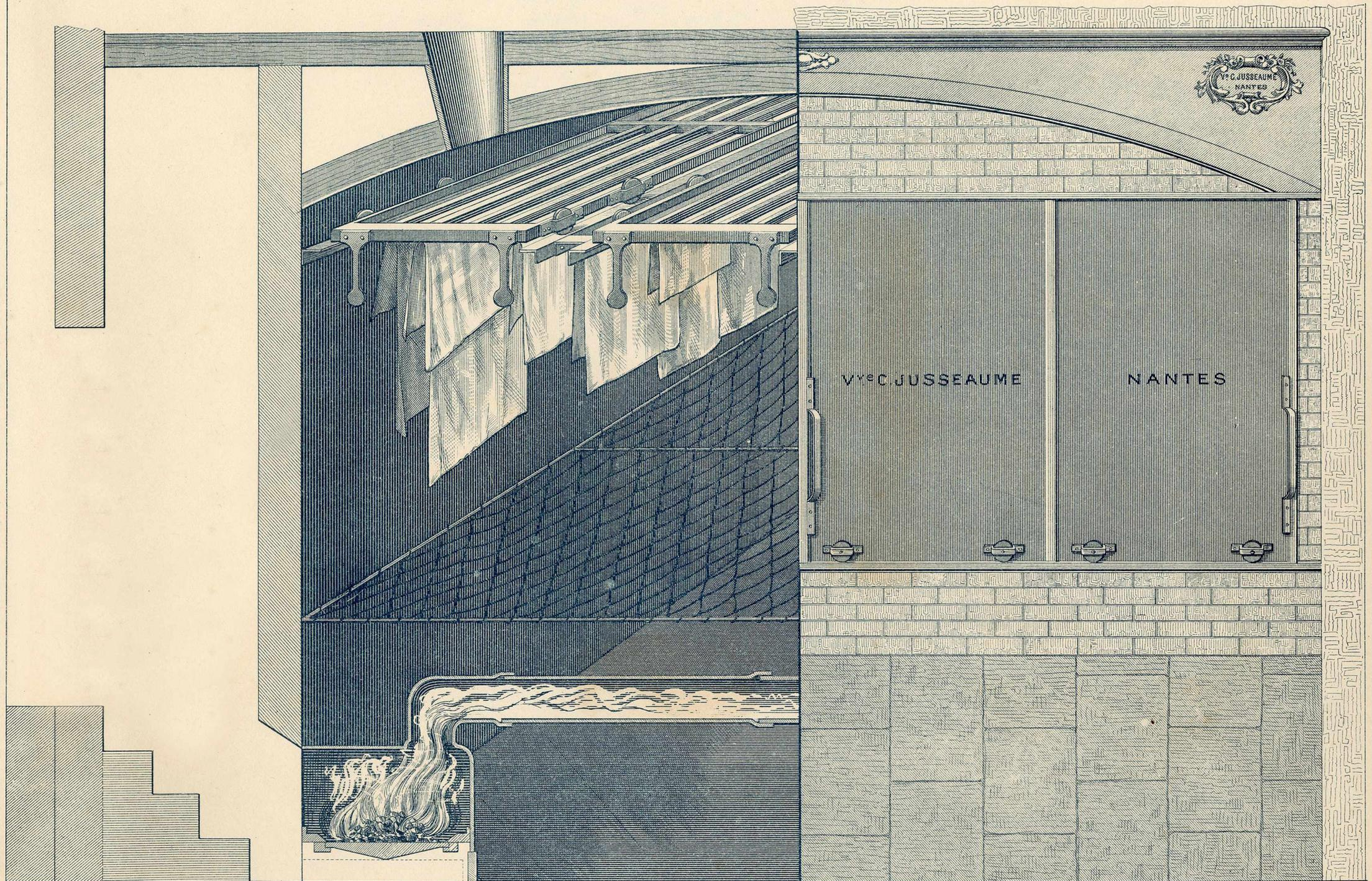
Séchoir à air chaud pour blanchisseur et communautés, avec portes en tôle, charriots en bois roulants sur rails pour recevoir le linge; conduit de fumée rejoignant une cheminée, prises d'air intérieures pour l'évaporation de la vapeur. Cet appareil se fait de toutes dimensions et est indispensable pour sécher promptement le linge pendant l'hiver.
