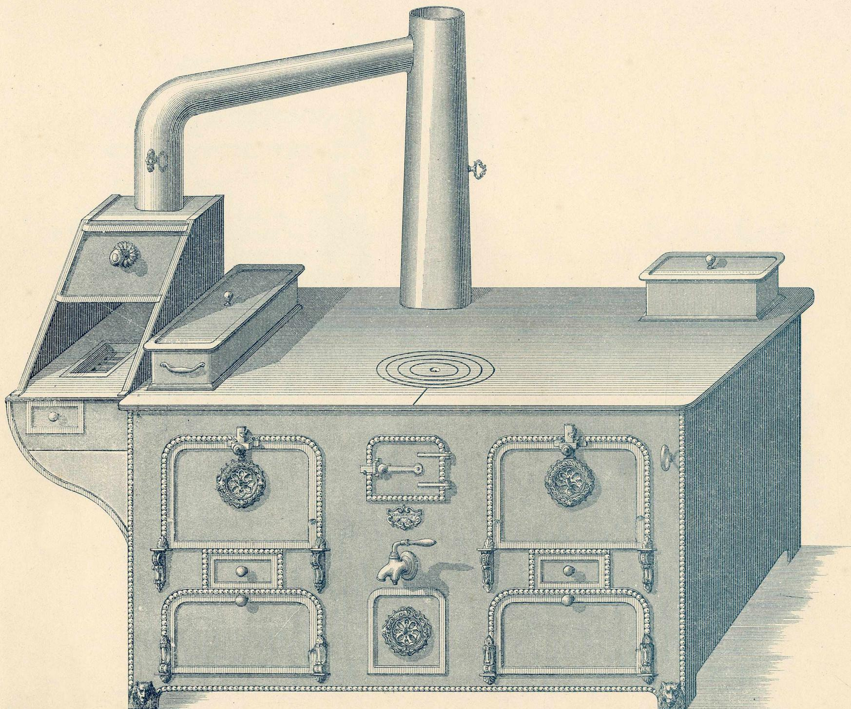
**FOURNEAU** économique en tôle, façade de fonte, à deux fours avec étuves, poissonnière, chaudière à eau en cuivre rouge étamé et grillade. Ce modèle se fait aussi sur pieds et sans poissonnière.
