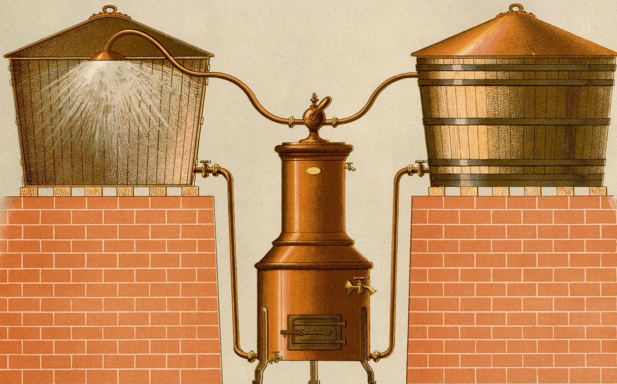
**APPAREIL** à lessive en cuivre à double circulation se plaçant devant une cheminée entre deux cuiviers en bois ou en métal, de 1,000 à 1,500 litres de contenance. La lessive se fait seule et demande environ 6 heures pendant lesquelles il n'y a qu'à entretenir le feu dans le foyer de l'appareil pour maintenir un arrosage régulier. Au moyen du robinet à deux eaux placé au sommet, on se sert à volonté des deux cuiviers ou d'un seul.
