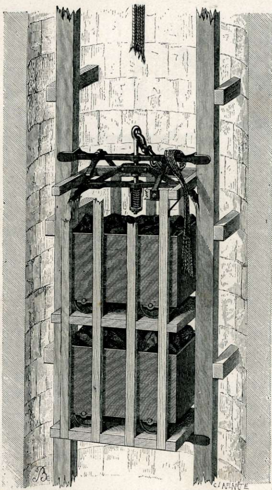
FIG. 58. — Parachute Fontaine après la rupture du câble.
