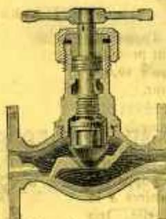
Robinet à soupape, coupe verticale laissant voir le mode de fermeture.
