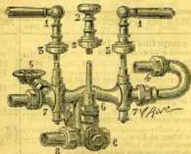
Appareil de bains avec entrées d'eau chaude et d'eau froide, sortie et trop-plein, le tout fonctionnant par le fond de la baignoire.
