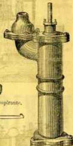
Corps de pompe à soupape de sûreté à colonne cylindre aspirant et bride ronde.
