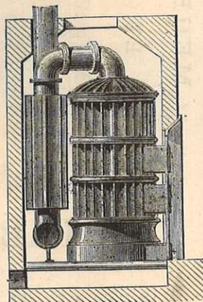
N. B. — Ne pas confondre l'appareil à ailettes creuses avec les appareils à lames ou à nervures, qui n'agissent que par rayonnement. Le calorifère à ailettes creuses agit par renouvellement constant des couches d'air entraînées dans les tubes ou ailettes creuses.
