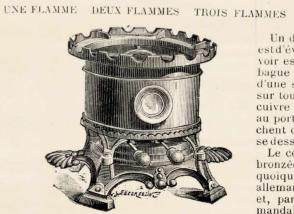
Un des avantages de ces nouveaux Réchauds est d'éviter toutes chances d'incendie. Le réservoir est en cuivre serti et non soudé sur une bague en fonte. Le porte-mèches est en fonte d'une seule pièce et les mèches sont conduites sur toute leur largeur par deux rouleaux en cuivre dentelés. Ces rouleaux sont maintenus au porte-mèches par deux pivots qui les empêchent de se déplacer, ils ne peuvent donc pas se dessouder.
