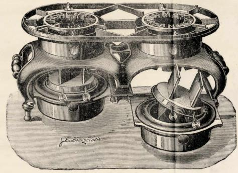
L'avantage de nos Réchauds à pétrole nos 8, 9, 10, 11, consiste en une plaque mobile à coulisse, qui supporte le bassin et permet de le glisser en dehors du corps du Réchaud, comme l'indique le dessin du Réchaud no 9, avantage très-important, en ce sens que lorsqu'on doit toucher, soit au bassin pour remettre du pétrole, soit aux mèches, on peut le faire sans déranger le corps du Réchaud, ni les casseroles placées dessus.
