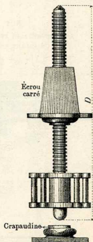
Avec écrou à lanterne quatre branches claveté sur l'arbre.
