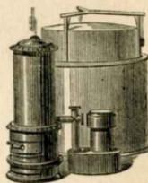
Fig. 406. — Appareil pour la production du gaz d'huiles végétales.
