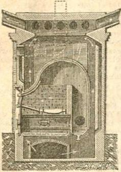
foyers en pièces réfractaires. Ces appareils sont les seuls qui soient indépendants des enveloppes en briques. 20 types sont établis pour chauffer de 200 à 50,000 mètres cubes.
