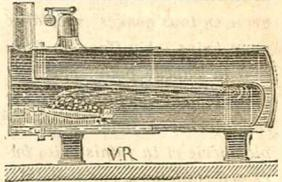
**Chaudières horizontales à foyer extérieur avec maçonnerie**, TUBULAIRES OU A BOUILLEURS DE TOUTES FORCES. CES CHAUDIÈRES CONVIENNENT SPÉCIALEMENT AUX GRANDES INSTALLATIONS.
