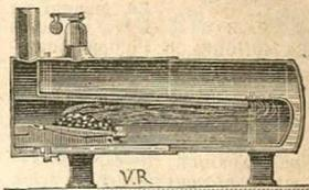
Chaudières à foyer extérieur avec maçonnerie.
