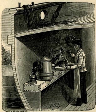
FIG. 143. — Cuisine à vapeur à bord d'un yacht (Egrot).
