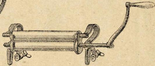
Essoreuse avec monture galvanisée
