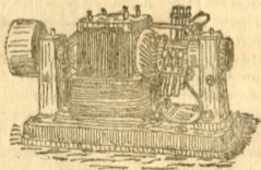
Fig. 18. — Dynamo Rechiniewski, type supérieur .
