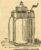
Fig. 5. — Pile Leclanché à vase poreux.
