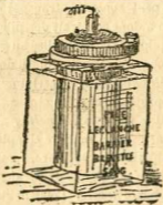
Fig. 3. — Pile Leclanché-Barbier à aggloméré cylindrique.
