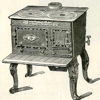
Ces poêles sont à **flamme renversée ou ambiante**; les fours sont très grands et avec porte abattante; la platine de devant est mobile. Deux ailes qui s'adaptent de chaque côté de la buse permettent de donner plus de largeur au-dessus. La chaudière est mobile et s'accroche derrière le foyer.
