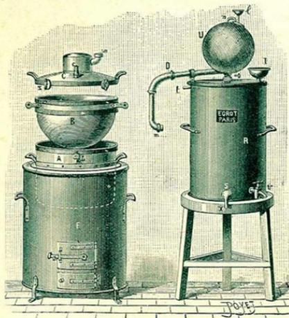
FIG. 11. — Alambic à usages multiples avec Rectificateur Egrot.
