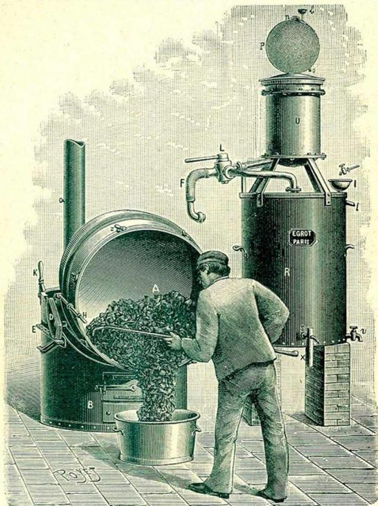
FIG. 179. — Alambic brûleur à bascule avec Rectificateur à colonne.
