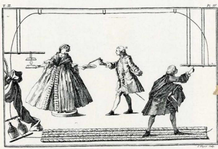
Expérience sur la transmission de l'électricité à travers des corps vivants et inertes.
