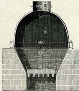
Ce foyer, destiné surtout au chauffage des serres et des étuves, se compose :
