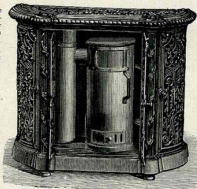
Ce foyer est formé d'un cylindre en tôle avec grille et cendrier mobile. Il tourne sur un axe qui sert en même temps de tuyau de fumée. Ce système permet de faire sortir le foyer du meuble pour que la chaleur se répande plus vite dans l'appartement.
