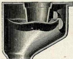
Sauf indications contraires, les coffres sont fournis en fonte émaillée intérieurement et, sur demande, en fonte ordinaire. Les tourillons du clapet reposent sur des coussinets en verre.
