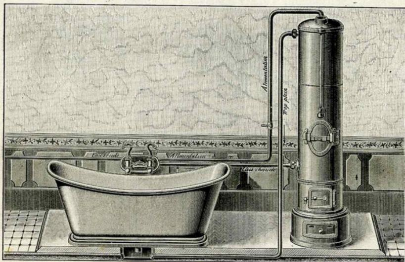
Ce chauffe-bains se compose d'une chaudière en tôle galvanisée et, **sur demande**, en cuivre rouge; elle est posée sur un fourneau à socle, en fonte, et traversée dans toute sa hauteur par un tuyau en cuivre rouge faisant office de cheminée.
