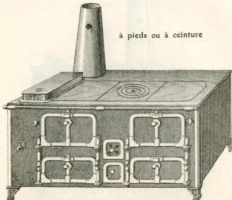
Se composant de deux fours à retour de flamme, de deux étuves ou fours tempérés, d'une chaudière avec robinet, de deux registres avec poignées-olives sur la façade, pour régler et diriger la chaleur et de deux cendriers dont un tamiseur.
