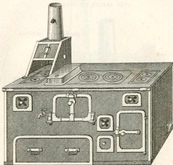
Se composant d'un four à retour de flamme, de deux poissonnières formant réchauds, d'un chauffe-assiettes, d'une chaudière avec robinet, d'une grillade avec double départ et d'un charbonnier monté sur galets.
