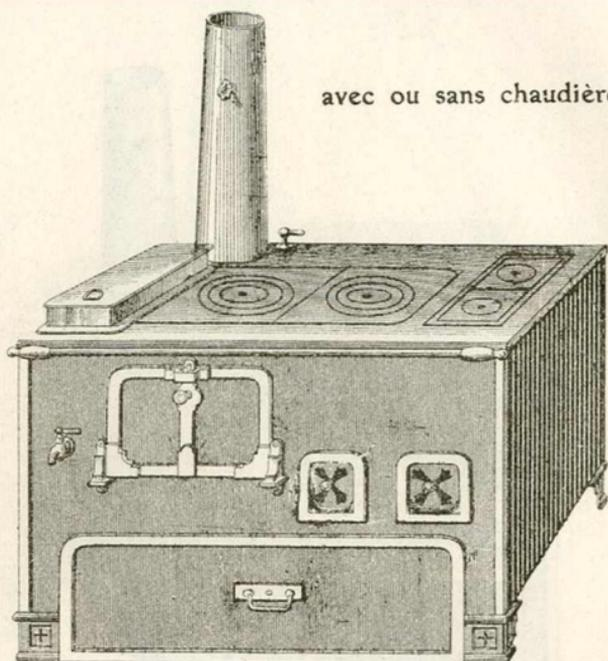
Se composant d'un four à retour de flamme, d'une chaudière avec robinet, d'une poissonnière formant deux réchauds, de deux cendriers et d'une arcade recevant un charbonnier monté sur galets.
