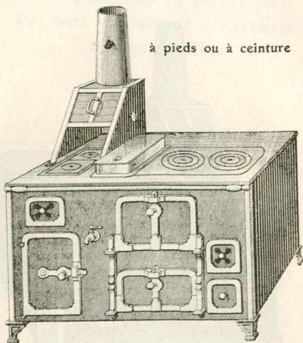
Se composant d'un four à retour de flamme, d'une étuve ou four tempéré, d'un chauffe-assiettes, d'une chaudière avec robinet, d'une poissonnière formant deux réchauds, d'une grillade avec double départ.
