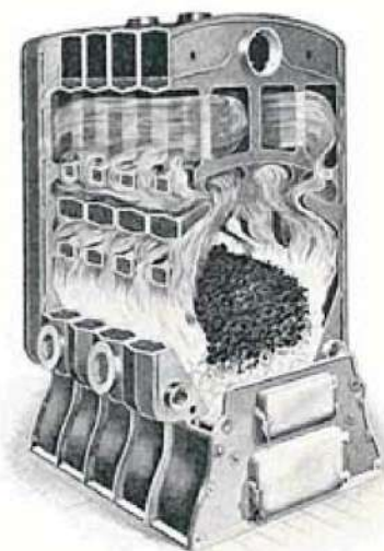
Chaudière "Idéal" Sectionnée Pour Vapeur. Vue en Coupe.
