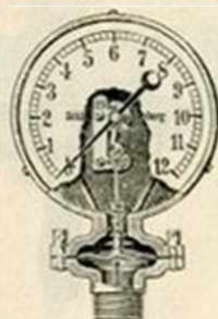
Manomètre à disque ondulé pour pressions jusqu'à 20 kgs.
