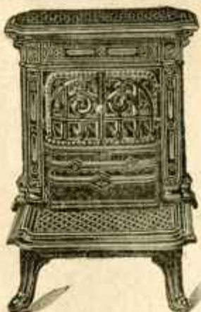
Cheminée parisienne, foyer en terre réfractaire, tuyau derrière avec portes mica, fonte noire. Hauteurs : 0 m 57 0 m 60 0 m 64 0 m 68 0 m 77 Largeurs : 0 m 42 0 m 45 0 m 48 0 m 51 0 m 59 Fonte noire. 15.30 17.85 20.50 22.15 28. » Emailée noire. 20. » 23. » 27.25 31.90 39.25
