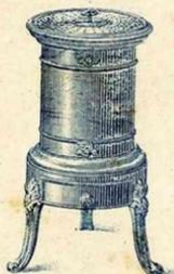
A houille. Buse derrière. Pieds mobiles. Couvrable à jour avec bouton fonte. Le dessus est muni d'un tampon. Un petit registre permet de régler l'activité de la combustion. Ils se livrent aussi sans porte, façade pleine.
