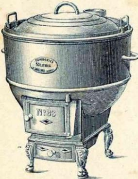
La couronne de trois centimètres de hauteur qui surmonte le bord de la chaudière empêche l'eau de condensation et d'ébullition de se répandre le long de l'enveloppe extérieure, celle-ci se trouve ainsi préservée d'une détérioration trop rapide et se maintient toujours propre.
