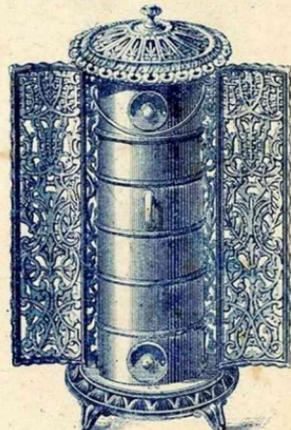
Le foyer consiste en un long cylindre muni d'une poignée permettant de le sortir de l'appareil pour le nettoyer et le charger. Les N<sup>os</sup> 91 à 95 sont pourvus d'un cendrier mobile et d'une porte à coulisse pleine en fonte. Sur demande et moyennant majoration on livre avec portes ajourées garnies de mica.
