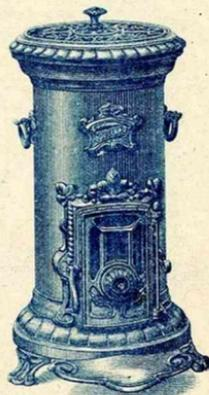
Calorifères composés d'un fût en tôle glacée et moulurée garni intérieurement de briques réfractaires, d'un socle et d'un chapiteau en fonte avec couvercle variable comme l'indiquent les dessins.
