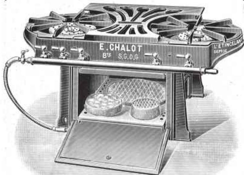
Le n° 3 est muni d'un four à pâtisserie qui s'adapte à la rôtissoire en enlevant la casserolerie. Le four est à double enveloppe (Breveté S.G.D.G.), et est chauffé dessus par un plafond d'amiante et dessous par une rampe. Le dessous du four peut s'enlever pour glacer une pièce
