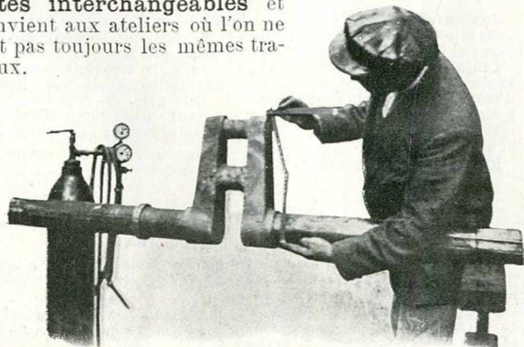
PIÈCE EN ACIER DE 40 C/M. SOUDÉE AU CHALUMEAU
