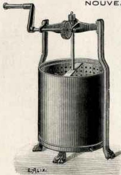
En trois minutes l'on peut essorer vingt chemises ou le linge équivalent sans que le linge subisse aucune fatigue, ce qui arrive lorsqu'on le tord à la main, en ayant de plus le grand avantage de ne laisser aucune goutte d'eau. Le linge fin peut être repassé presque aussitôt.
