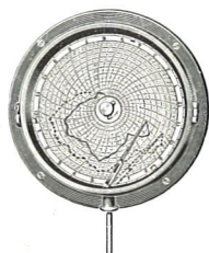
Fig. 202. Enregistreur à fixation par collerette.
