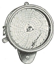
Fig. 201. Enregistreur sur disque circulaire à fixation par pattes.
