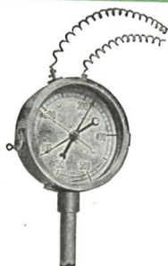
Fig. 153. Thermomètre à aiguilles min. et max. et contacts électriques.
