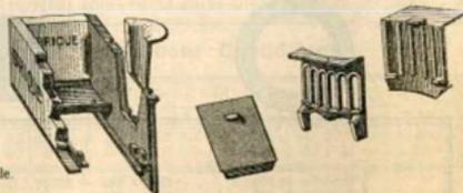
Porte-grille et plaque de côté de four avec parabole
