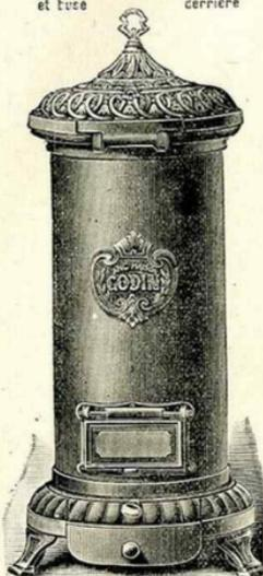
Les calorifères hygiéniques N<sup>os</sup> 420 à 425 sont garantis intérieurement de briques réfractaires. Ils possèdent à la partie inférieure une porte coulissante qui sert au réglage de l'entrée de l'air. On fait tomber les cendres au moyen de la targette placée sous la sole, se manoeuvrant au moyen de la frotte avec anneau placée sur le socle. Ils possèdent un tiroir en tôle.
