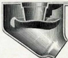
Sauf indications contraires les coffres sont fournis en fonte émaillée intérieurement et, **sur demande**, en fonte ordinaire. Les tourillons du clapet reposent sur des coussinets en verre.
