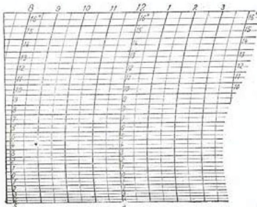
Ainsi, en examinant les deux graphiques représentés en vraie grandeur (fig. 4 et 5) (tels qu'ils résultent de la graduation par comparaison du thermomètre enregistreur décrit ci-après), on voit que l'intervalle correspondant à un degré est sensiblement cinq fois plus grand à 44 degrés qu'à 5 degrés au-dessous de zéro.
