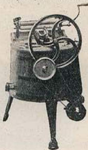
Fig. 19. — Machine « Nec plus ultra » actionnée par moteur électrique.
