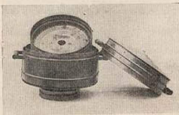
Fig. 99. — Four Utilo, couvercle enlevé et sections démontées.
