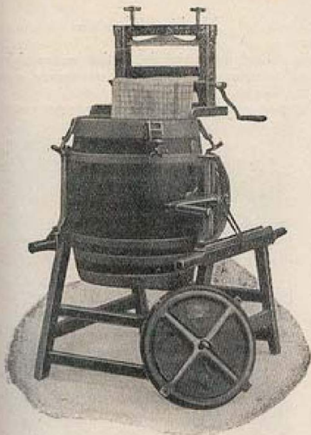
Fig. 13. — Machine La Samo avec essoreuse montée sur la cuve.
