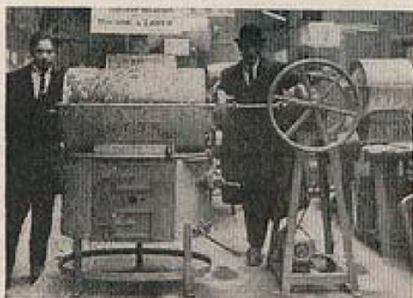
Fig. 12. — Machine Gyor commandée par moteur électrique.
