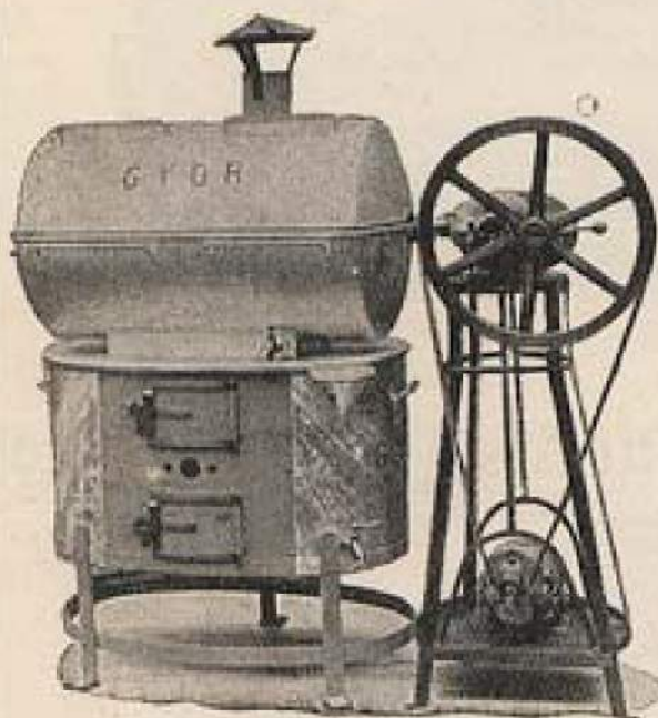
Modèle marchant mécaniquement avec moteur électrique
