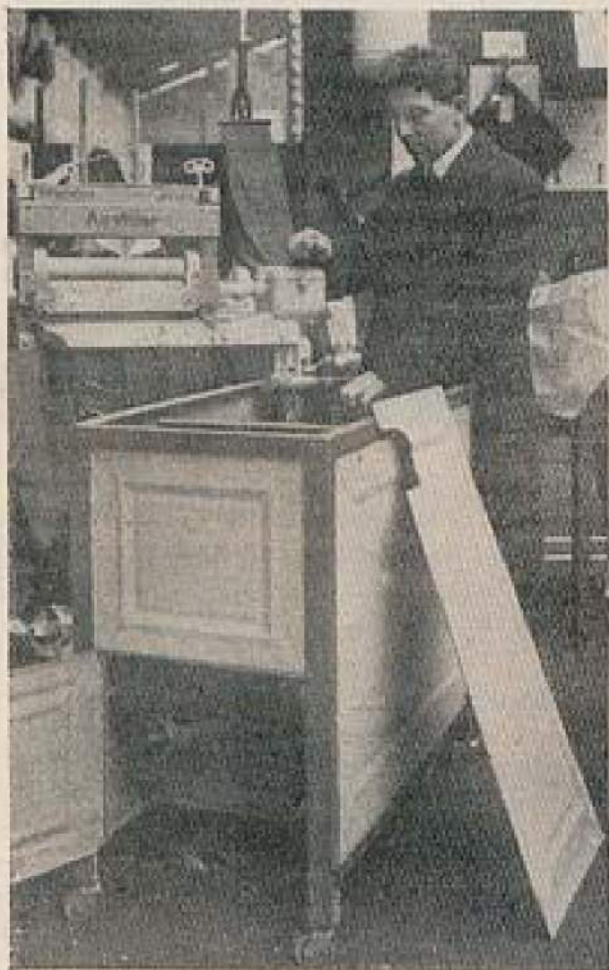
Fig. 18. — Machine Maison Moderne à essoreuse pivotante.
