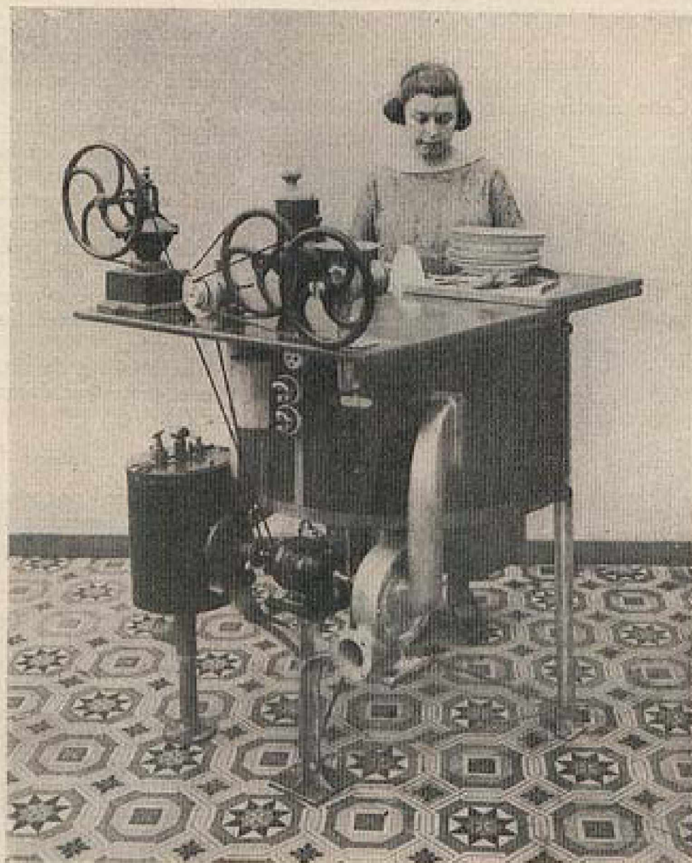
Fig. 31. — Machine à laver la vaisselle « La Centrifuge », grand modèle, à panier tournant, pompe et ventilateur centrifuges. Le même moteur peut commander des appareils accessoires variés.
