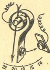
Fig. 110. - Régulateur à bilame.
