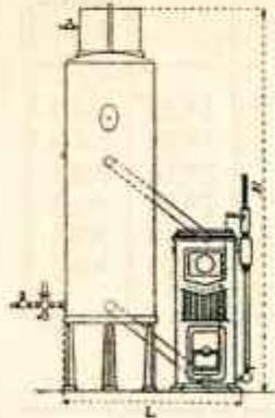
N° 3338-1. — Groupe comprenant une chaudière "Idéal" n° 1 de 6000 calories, avec réservoir de 200 litres.
