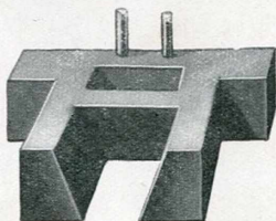
BOUILLEUR DE FOND AVEC CHUTE DE FUMÉE
