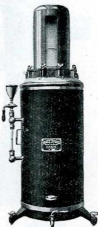
Fig. 769. — Manomètre différentiel.
