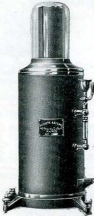
Fig. 767. — Manomètre à cloche.
