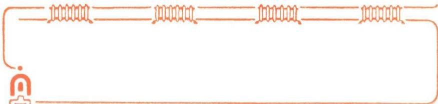
Un autre avantage de l'eau chaude, c'est que la chaudière peut très bien être placée de plain-pied avec les radiateurs, alors que dans la plupart des cas, la chaudière à vapeur doit être disposée en sous-sol et souvent même dans une fosse.
