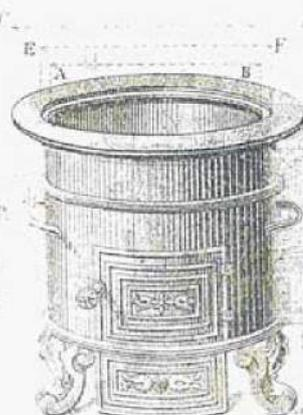
Fourneau avec hausse pour lessiveuse fond rétréci
