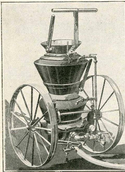
FIG. 8. — APPAREIL A GUNITER
