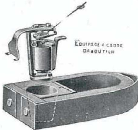
Ces appareils ont, pour les mesures sur courant continu, l'avantage d'être d'une *plus grande précision* que les électromagnétiques.
