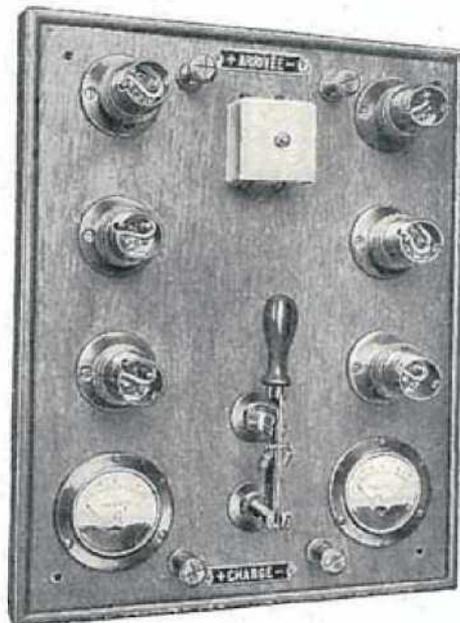
Tableau en chêne verni avec appareillage nickelé comprenant : 1 interrupteur, 1 coupe-circuit, 6 douilles à baïonnette ou à vis, 1 voltmètre et 1 ampèremètre, 2 bornes d'arrivée et 2 de charge, le tout monté pour isolement 250 volts.
