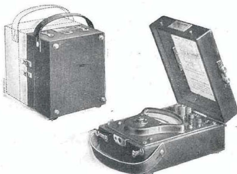
**Objet.** — Les appareils suivants permettent de faire toutes les mesures d'intensité et de tension et constituent d'excellents modèles d'ampèremètres et de voltmètres de contrôle industriel.
