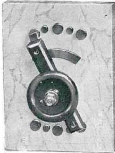
Ces commutateurs bipolaires sont destinés à brancher un *voltmètre* successivement sur plusieurs ponts.
