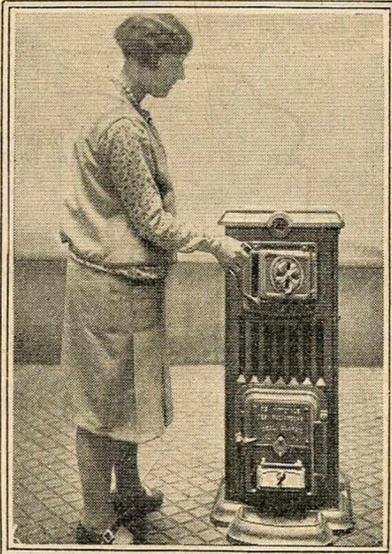
L'introduction du charbon produit souvent des flammes bleues et « sautantes », indice d'une combustion incomplète de la distillation des hydrocarbures; ouvrir alors la rosace jusqu'à disparition de ces flammes bleues.
