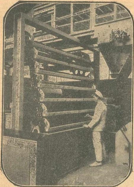
Voici des moules destinés à la production intensive du pain. A mesure que les rangées de moules sortent automatiquement des fours, où ils ont été lavés et séchés, un ouvrier les enduit de graisse de façon à ce que le pain n'adhère pas. Les moules sont ensuite portés à l'endroit où la pâte est préparée, et remplis.
