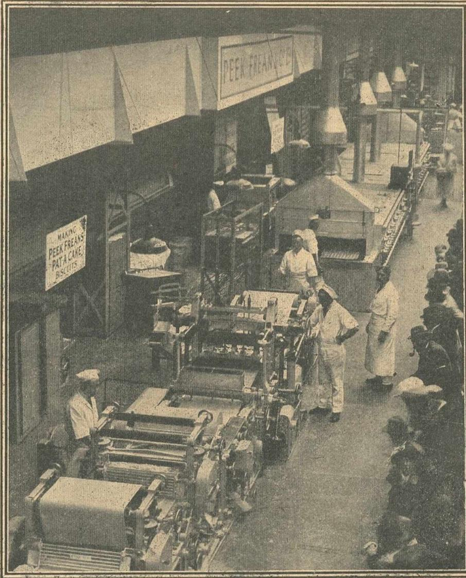
Vue générale d'une biscuiterie moderne. Les gâteaux et les biscuits sont fabriqués par un système contenu dans l'ensemble de machines placé, à gauche, au premier plan ; ils passent directement des fours à la section d'emballage à l'arrière-plan.
