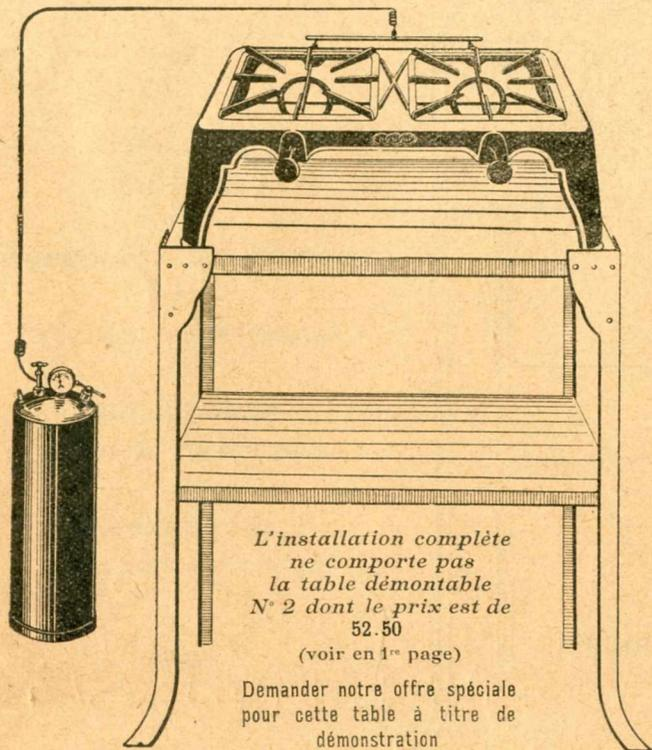
Un réservoir de 5 litres de capacité réelle d'essence, en tôle soudée à l'autogène, avec manomètre indicateur de pression, bouchon-valve formant bouchon de remplissage et robinet d'arrêt d'essence.
