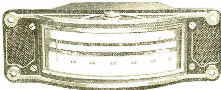
FIG. 13. — Vue d'un pyromètre enregistreur Carpentier-Intégra.
