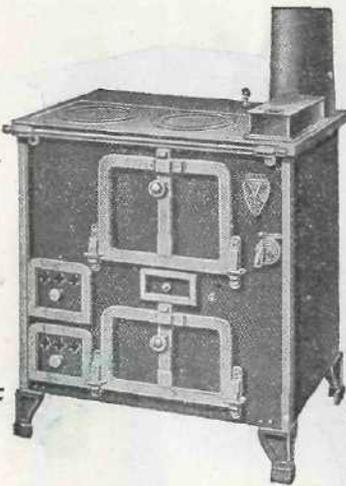
N° 879. — Fourneau à retour de flamme. Façade et côtés tôle, dessus fonte. Cendrier trieur en tôle d'acier emboutie. Chaudière émaillée, panache et couvercle cuivre. Foyer à charbon. Long<sup>r</sup>: 70 $\frac{1}{2}$ %; larg<sup>r</sup>: 50 $\frac{1}{2}$ %. Chaudière: 7 lit.
