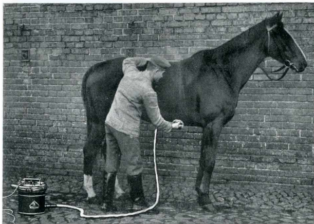
Limpieza de un caballo con la almohaza de aspiración adaptada al aspirador de polvo «Protos»
