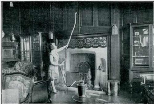
Fig. 1. — DEPOUSSIERAGE D'UNE CLOISON A L'AIDE D'UN ASPIRATEUR DU TYPE A SEAU (ASPIRON)
