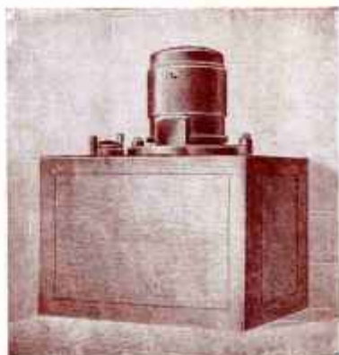
Fig. 4. Machine " BOREAS " type 250 frigories heure à circulation de saumure.
