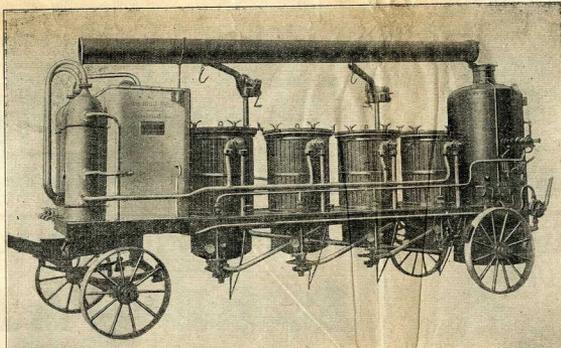
Nouveaux appareils mobiles avec rectificateurs à circulation d'eau intérieure permettant et à volonté des alcools de 52 à 85° sans repasse avec épouséement complet de toutes matières à distiller
